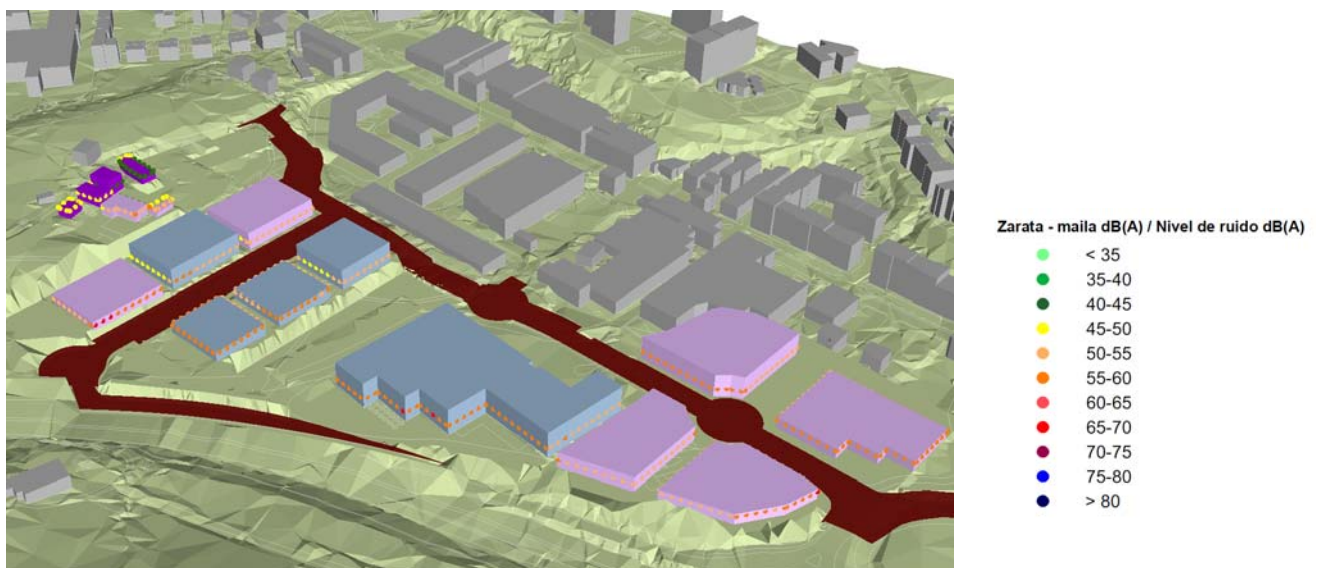
Figura 4: Vista (NO) de los niveles de ruido en fachadas durante el periodo día (Ld).
