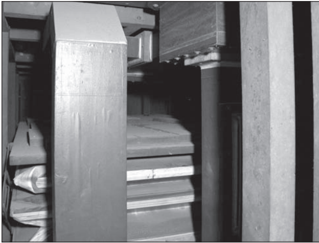
Vista del depósito general y portavientos del órgano de Andoain. Toda esta parte de la fuellería se encuentra alojada en el pedestal del órgano, sobresaliendo las palancas del sistema de bombeo manual por la parte trasera derecha del instrumento. En un segundo nivel se encuentran otros tres depósitos secundarios, que alimentan los secretos de las dos divisiones manuales y del Pedal.
