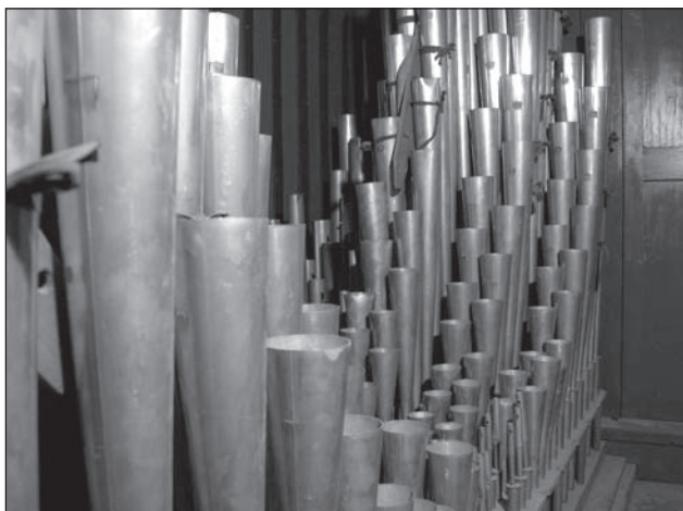
Vista parcial del Recitativo en la que se muestra la tubería que descansa sobre dos de sus secretos tras las persianas de expresión, que dan a la parte frontal del instrumento. El orden de los registros a partir de aquí es como sigue: Flauta Octavante, Corno de Noche, Voz Celeste, Fagot, Trompeta y Clarín. Los tubos más agudos de este último registro, como se ve, son labiales o de boca.
